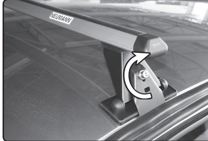
Pevně utažněte šroub M8x35 přiloženým klíčem (ibus č.6) rovnoměrně na obou stranách nosiče. Šroub neutahujte nadměrnou silou, aby nedošlo k deformaci bočního úchytu a špatnému upevnění nosiče.
