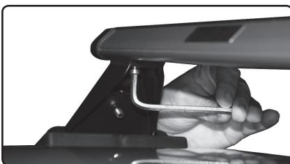
Překontrolujte pevné utažení šroubů M8x18 přiloženým klíčem (imbus č.6). Rozteč šroubu M8x18 s imbusovou hlavou, které fixují patky nosiče k tyči by měla odpovídat rozteč „D“ uvedené v tabulce na titulní straně.
