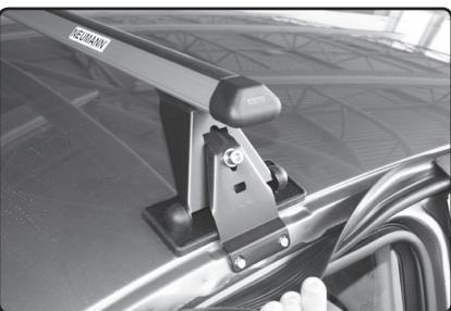
Boční úchyt navlékněte otvory na čepy. Překontrolujte zda je boční úchyt správně navléknutý do osazení čepu. Při zachycení pouze za hlavu čepu může dojít k uvolnění bočního úchytu a pádu nosiče ze střechy.
